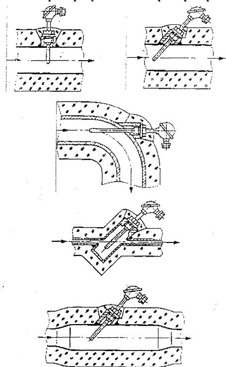
**Примечание:** Глубина погружения чувствительного элемента термопреобразователей от **0,3** до **0,5** Ду
