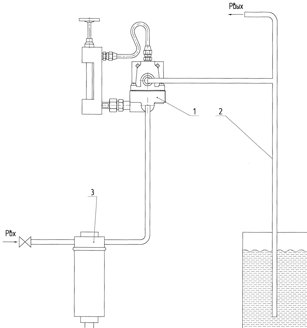
1 - регулятор расхода газа; 2 - трубка; 3 - фильтр;
