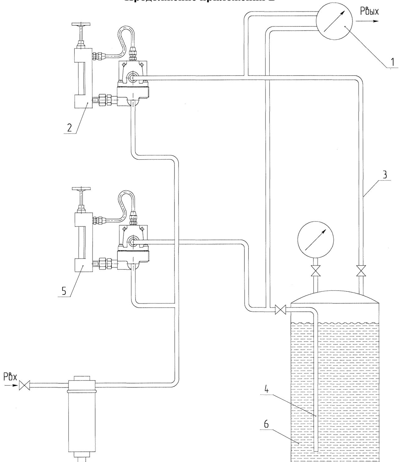
1 - дифференциальный манометр; 2 и 5 - регулятор расхода газа; 3 и 4 - трубка;
