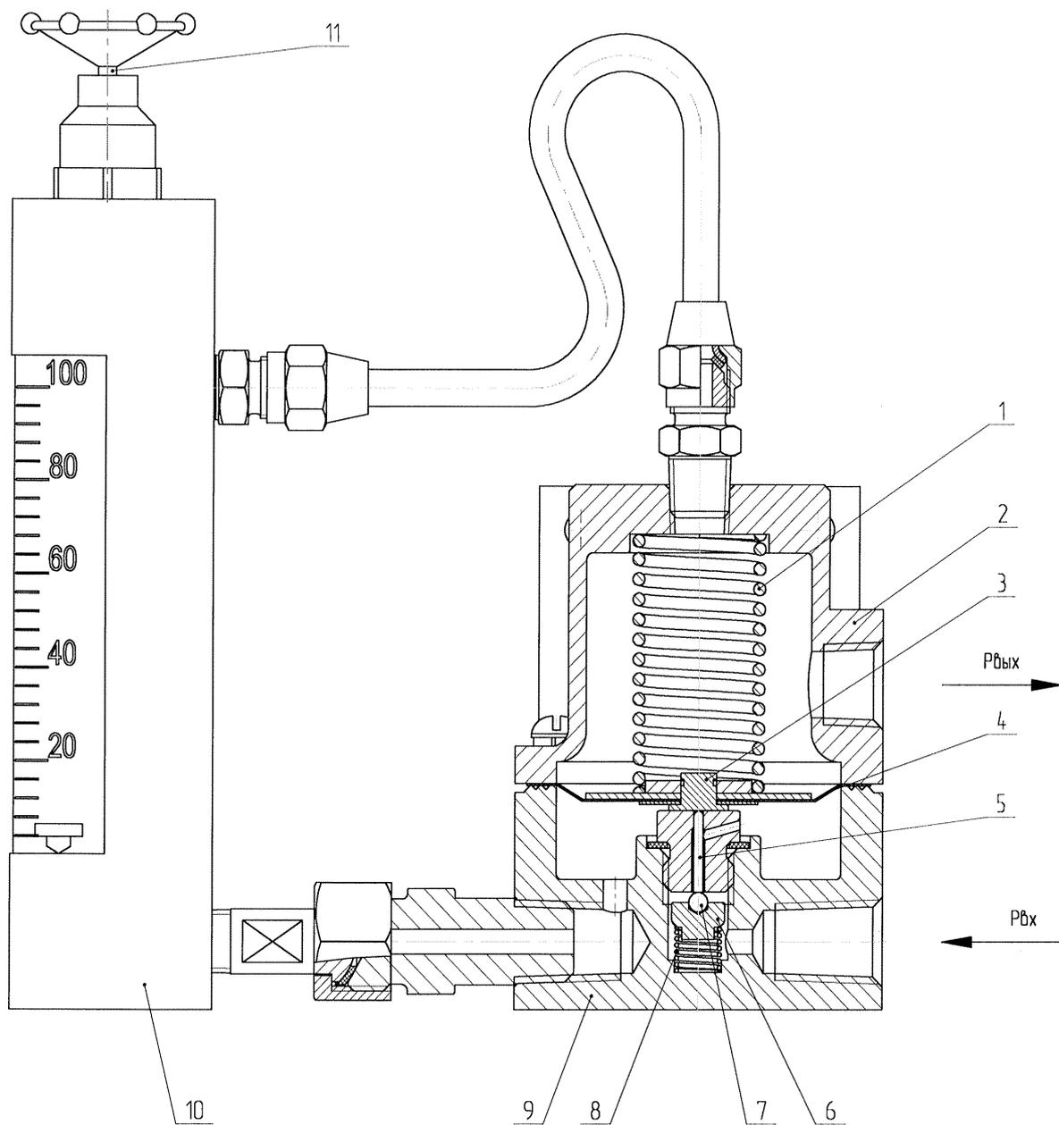
1 - пружина; 2 - крышка; 3 - центр; 4 - мембрана; 5 - толкатель; 6 - сопло; 7 - шарик; 8 - пружина; 9 - корпус; 10 - ротаметр; 11 - дроссель.
