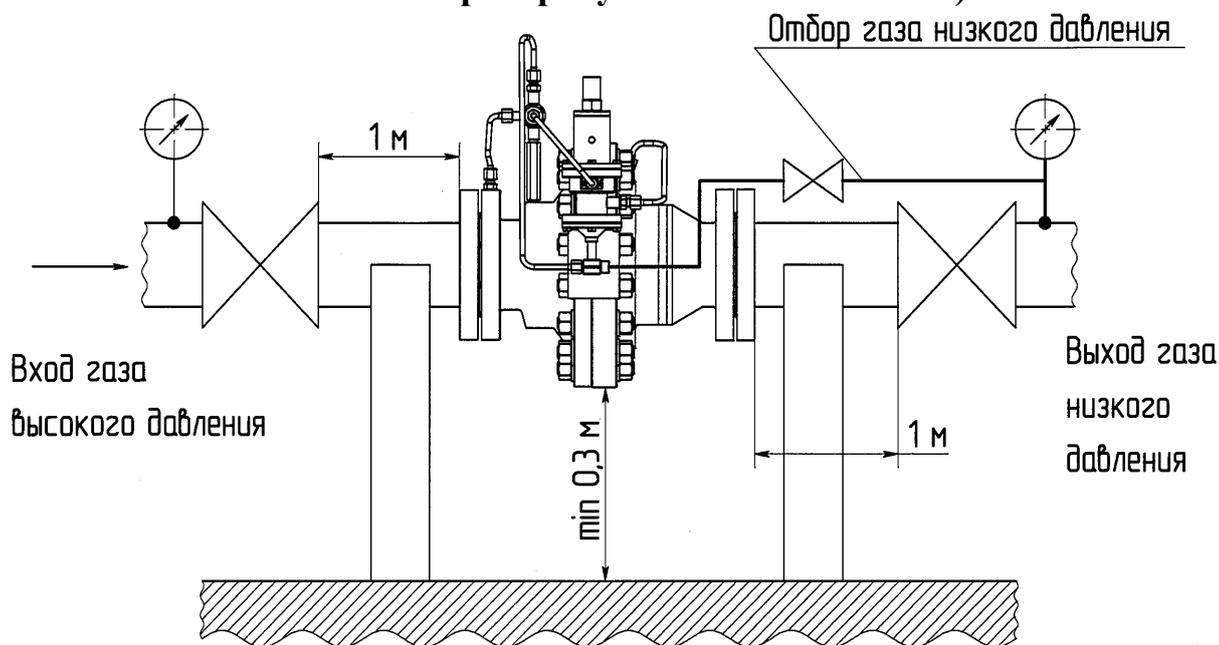
**Рисунок Б3: Рекомендуемая схема установки и обвязки регулятора давления газа РДУ-Т 64/100 и РДУ-Т 100/100 редуктором перепада с усилителем (теплогенераторы условно не показаны).**
