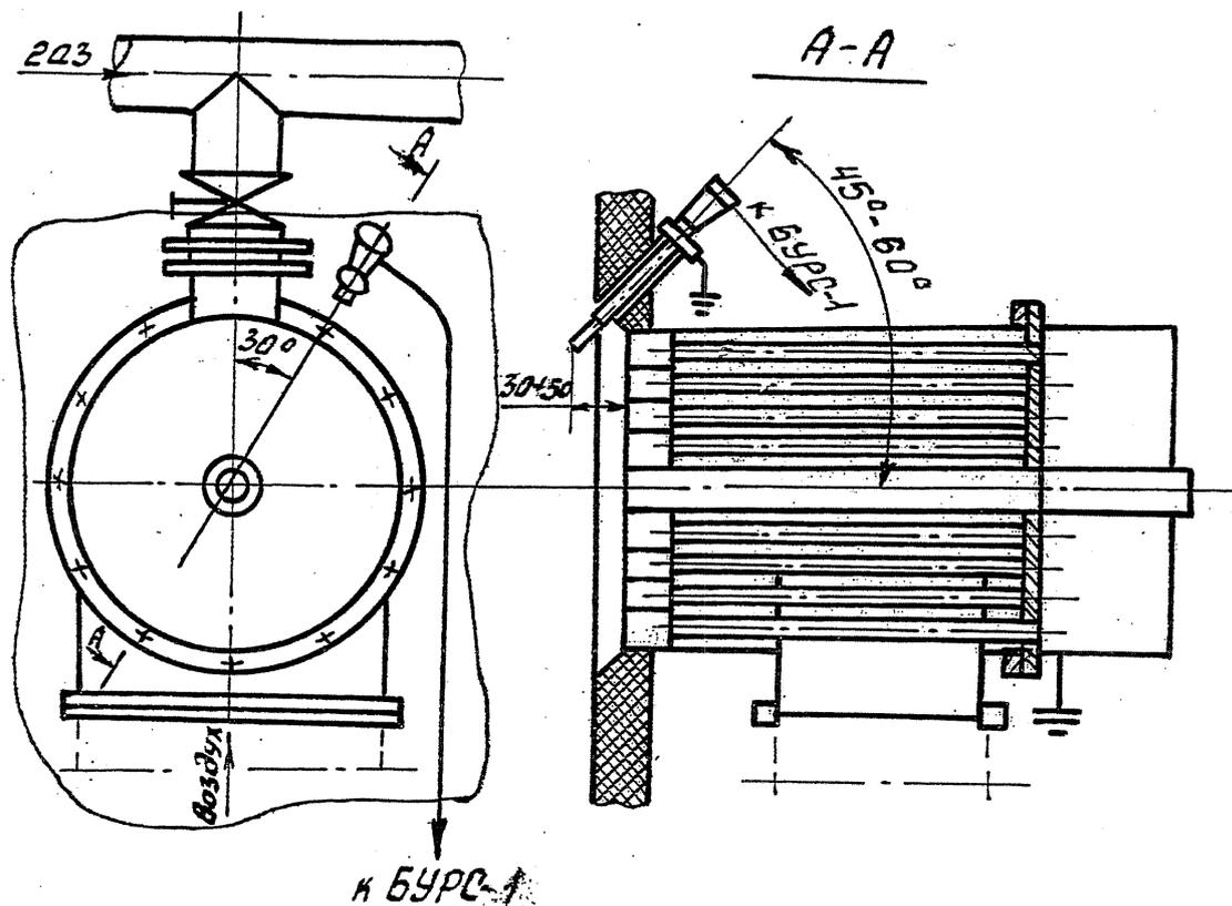
*Рис. 2. Установка контрольного электрода КЭ на измерительных газовых горелках*
