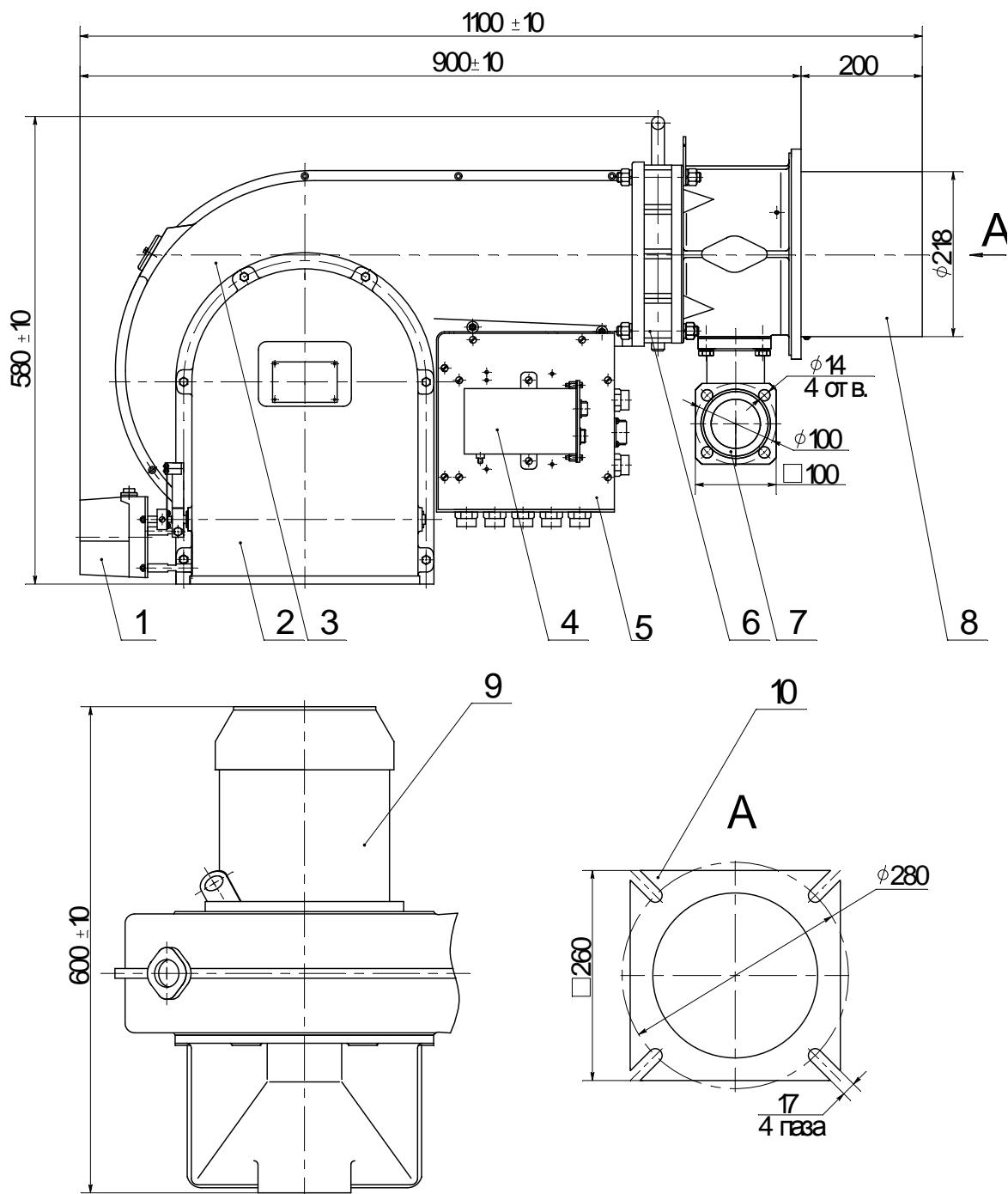
1. Электропривод воздушной заслонки;
