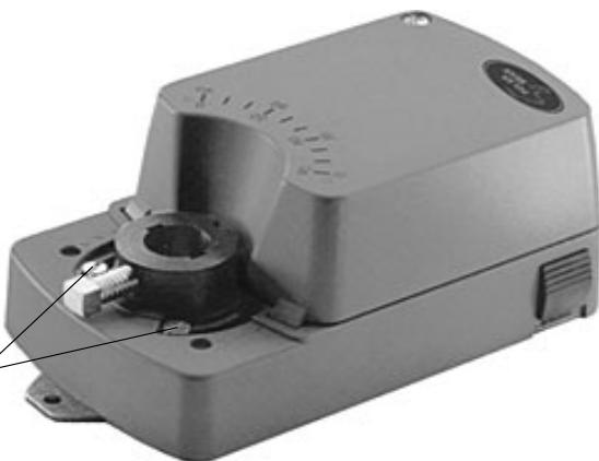
Настройка крайних положений газовой и воздушных заслонок производится путём изменения местоположения упоров сервопривода. Настройка положения газовой заслонки соответствующего пусковой мощности производится путем установки кулачка привода микровыключателя таким образом, чтобы контакты 24, 25 электропривода (см. приложение Е) находились в замкнутом состоянии.
