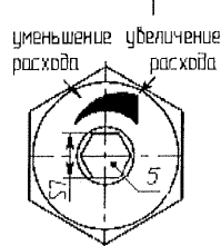
Рисунок А.15. – Габаритные и установочные размеры клапана КГЭЗ-100 с регулировкой расхода
