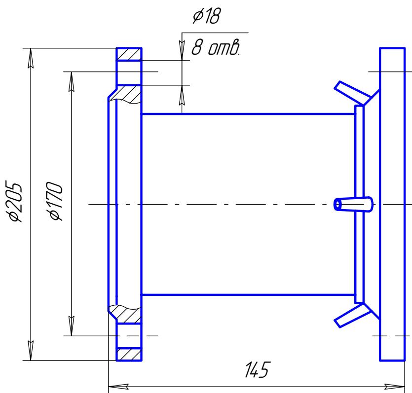
*Габаритные размеры и присоединение к пневматической сети
