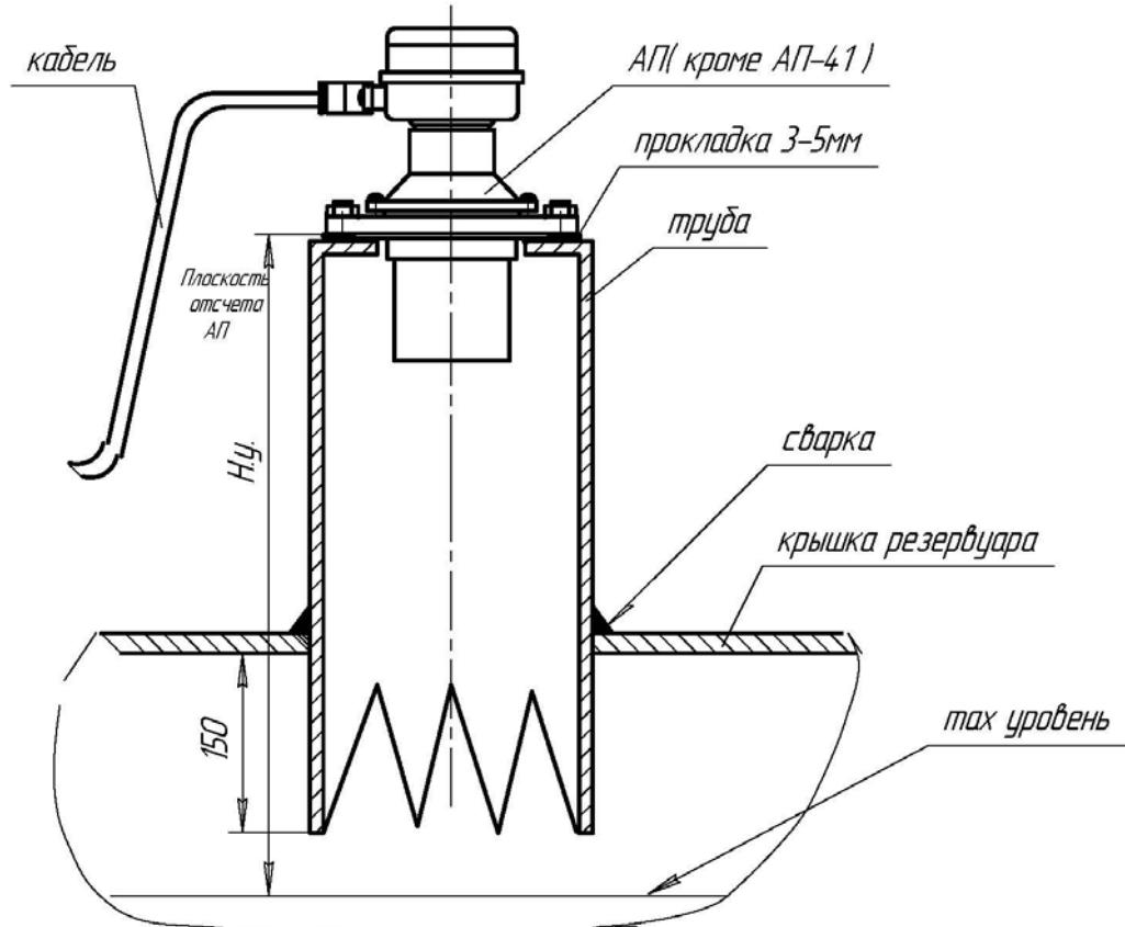
Схема для установки АП-6В, АП-61, АП-61В, Ап-9, АП-91, АП-9К.
