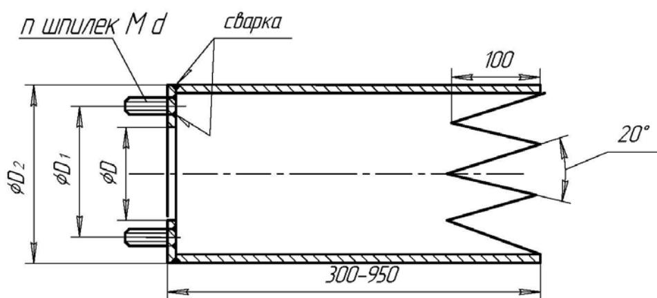
Размеры  $\phi D_1$ ,  $d$  и количество шпилек  $M$  выбирают согласно установочным
