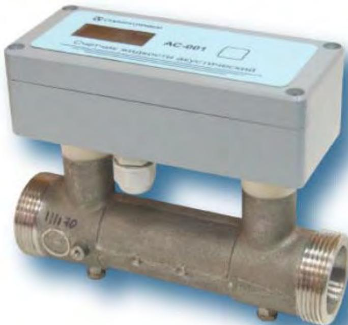
Основным предназначением счетчика жидкости является измерение текущего и суммарного расхода теплофикационной, холодной и горячей воды. При этом они могут использоваться и для измерения расхода других жидкостей, которые не вызывают коррозию первичных преобразователей, являются взрывобезопасными и имеют вязкость 0,5-30 ССТ.
